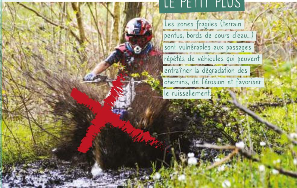
Les zones fragiles (terrain pentus, bords de cours d'eau...) sont vulnérables aux passages répétés de véhicules qui peuvent entraîner la dégradation des chemins, de l'érosion et favoriser le ruissellement.
